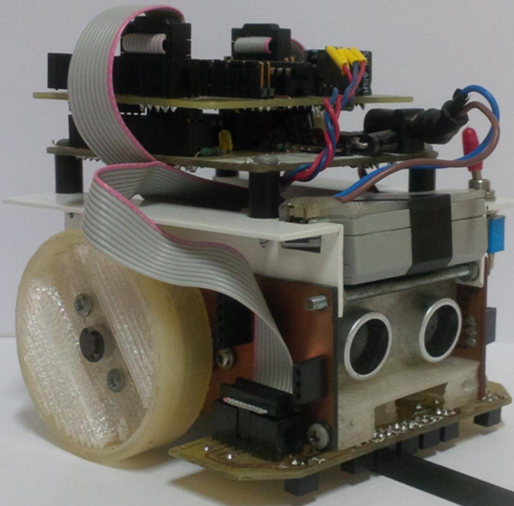
Robot stopař je závodní robot, schopný sledovat čáru na dráze. Pro pohyb používá motory z laserové tiskárny. O udržení na čáře se stará PD regulace, která zpracovává hodnoty ze sedmi čidel čáry. Celého robota pak řídí ATMEGA368, která se programuje ve vývojovém prostředí Arduino IDE. Periférie jsou k ní připojeny pomocí I2C expandéru. Motory jsou ovládány pomocí PWM skrze H můstek.
